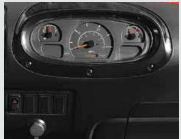
Tachometer, Stundenzähler, Anzeige für Tank, Blinker, Kühlwassertemperatur, Kontrollleuchten, Warnblinkanlage, 12 V Ladebuchse
